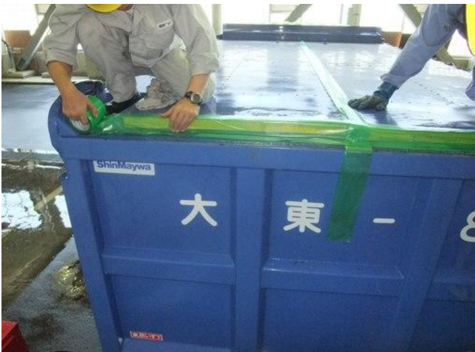
天蓋を閉め目張りする(2)
