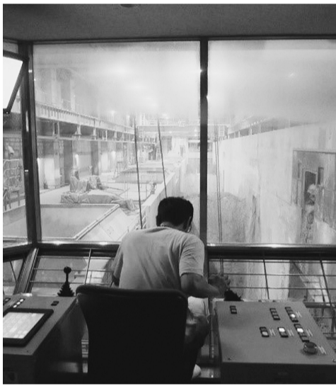
▲手動によるクレーンの操作
