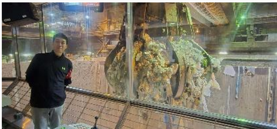
▲ 普段は自動運転のクレーンを特別に手動で行っていただきました。つかめる重さは9.6トン。星野議長と比べると大きさがわかります。
