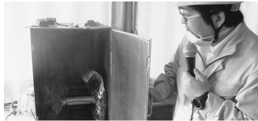
二段階目の測定、測定箱の中でサンプルを測定する
