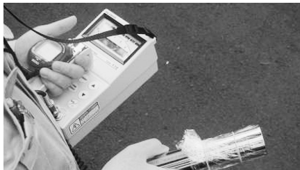
工場敷地内の放射線量を測定する港清掃工場職員
