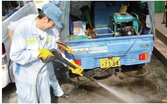
▲高圧洗浄機による散水作業
